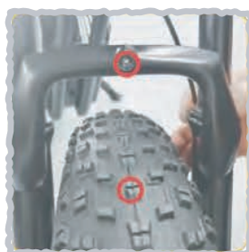
7. Установите колесо по центру вилки.
