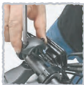
5. Отрегулируйте руль по центру выноса и зафиксируйте винты
