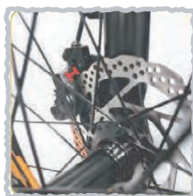
3. Отрегулируйте зазор между диском и вилкой
