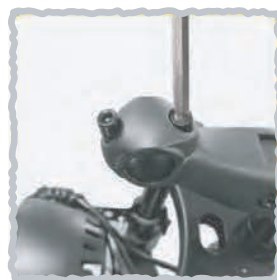
3. Снимите передние винты выноса
