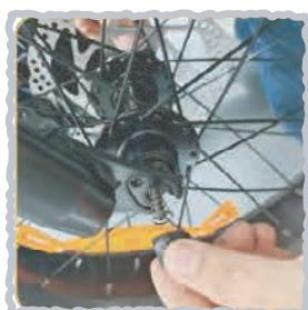
6. Установите пружину и зафиксируйте колпачок
