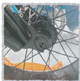
2. Установите переднее колесо
