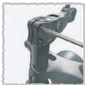
2. Удерживайте вынос и раму в одном направлении, затем зафиксируйте винт
