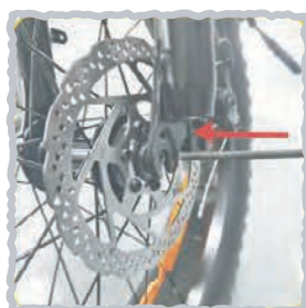
5. Снимите колпачок с эксцентрика и вставьте его в переднее колесо
