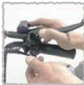
3. Затяните винт крепления ручки газа.
