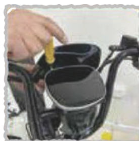
8. Установите ветровик и затяните его винтами.
